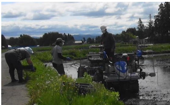
作業員3人での田植作業(自動運転田植機)
