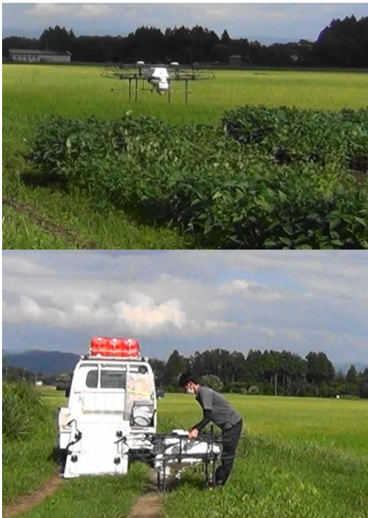
自動飛行ドローンによる薬剤散布(大豆)
