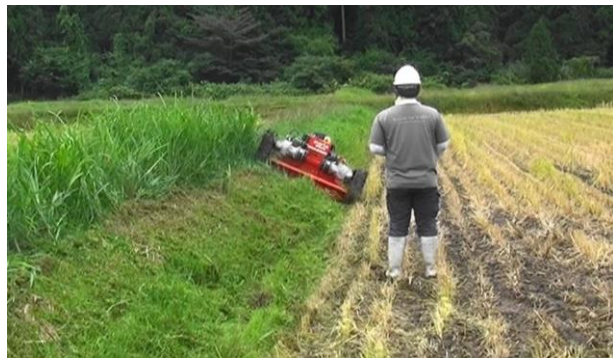
遠隔操作草刈機による作業
