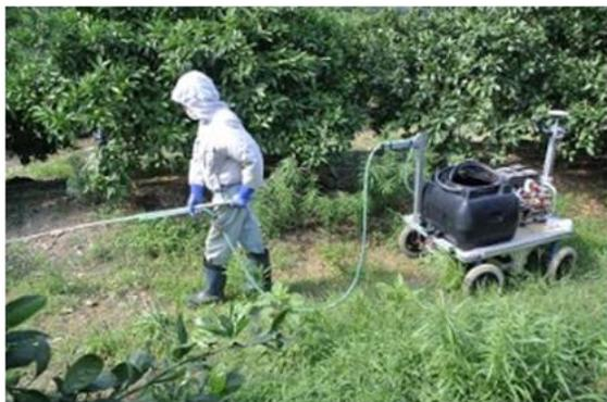
ロボットの追従走行機能を利用した施肥作業 (上) と除草剤散布作業 (下)
