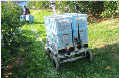
ロボットの自律走行機能を利用した収穫物運搬作業
