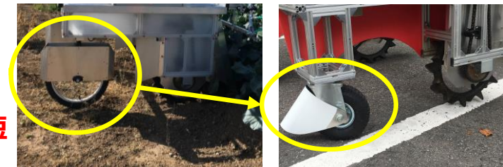
2020年度(旋回半径3.3m)→2021年度(旋回半径1.5m) 図6 UGV車輪の改良 ※旋回半径短縮のためキャスト方式に改良
