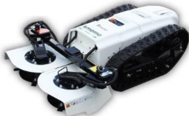
法面草刈り用アタッチメント装着
