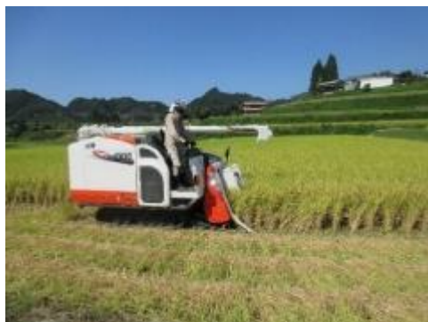
写真1 食味・収量センサー付きコンバイン
