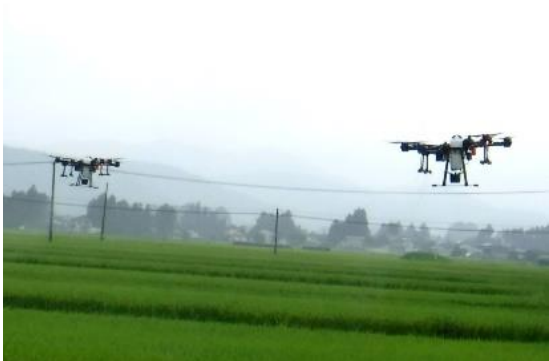
農薬散布用 マルチローター(ドローン) 自立飛行 実証面積 330a
