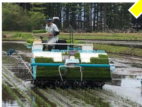
田植機(既存機) 8条植 自動操舵 実証面積 30a
