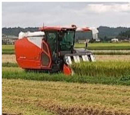
収量コンバイン 6条刈 単収等 自動記録 実証面積 7100a
