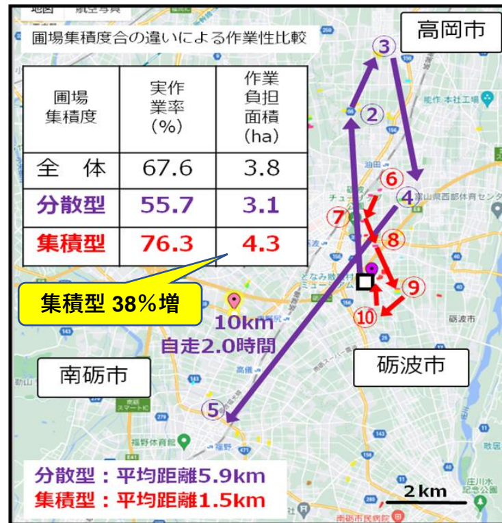
図4. 圃場間移動の収穫作業性シミュレーション
