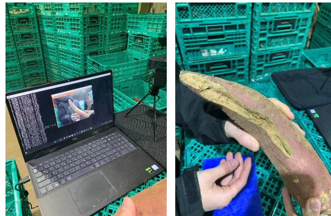
左：ベジワケールの稼働状況 右：B品に判別されたイモ
