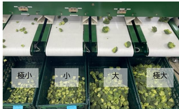
花蕾分割選別装置のフローレットカット部と選別ライン
