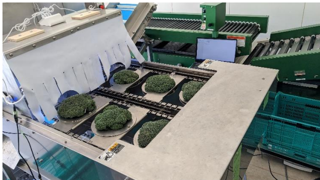
花蕾分割選別装置のフローレットカット部と選別ライン
