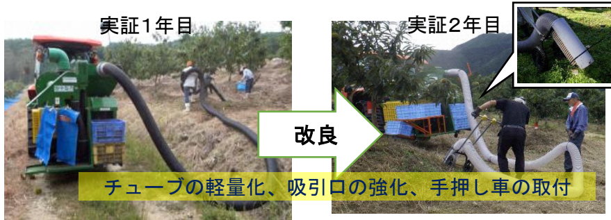
図15. 実証1年目、2年目のクリ収穫機による収穫作業の様子
