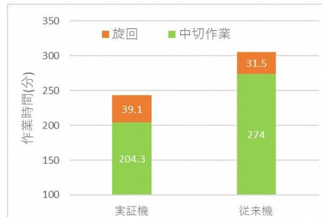
図1. リモコン中切機の作業時間(40a処理)
