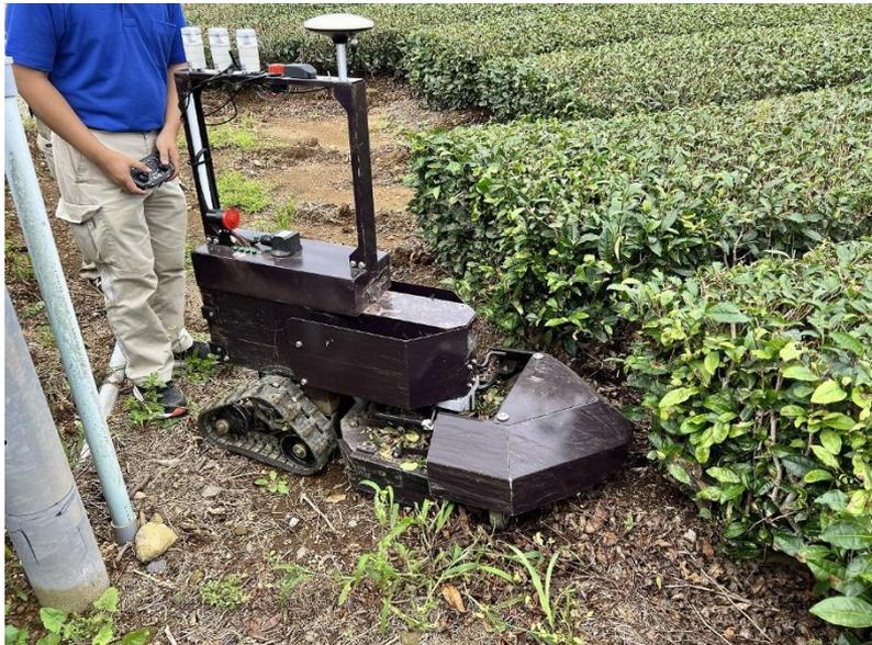
図6. 旋回中の自律式リモコン草刈機
