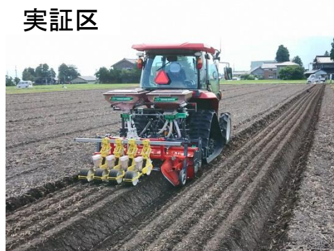
図6 既存トラクタ(慣行区)、直進アシストトラクタ(実証区)によるうね立て・施肥・は種
