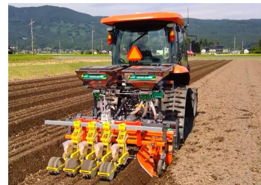
図4 直進アシストトラクタ・超砕土成型ロータリ・GPS可変施肥によるうね立て・施肥・は種
