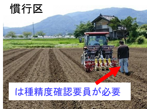
図6 既存トラクタ(慣行区)、直進アシストトラクタ(実証区)によるうね立て・施肥・は種
