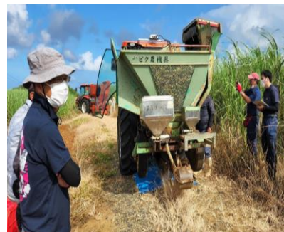
図8 R4/10/3 関係者によるGNSSトラクタ植付速度可変試験
