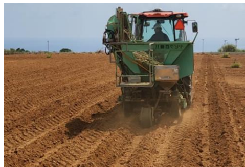
図8 R4/10/3 関係者によるGNSSトラクタ植付速度可変試験
