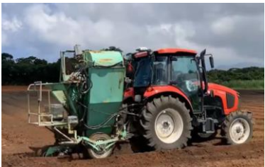
図5 GNSSトラクタと装着したビレットプランタ
