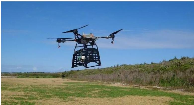
図16. R6年2月の散布試験および改良した新型散布装置(南大東島夕日の広場)散布作業は担当の(株)くみきで実施。
