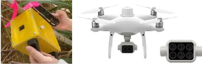
図9. 開発したモバイルNIR糖度センサーと空撮用ドローン
