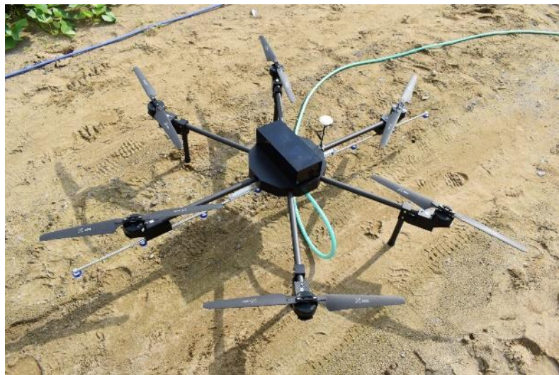
＜ホース装着型ドローンの機体＞
