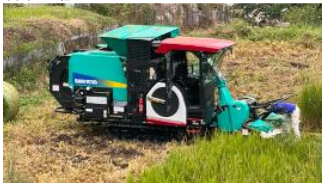
図12 汎用型微細断飼料収穫機による収穫
