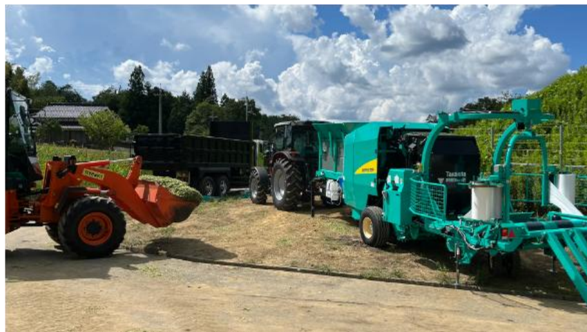
図10 細断型コンビラップによる調製
