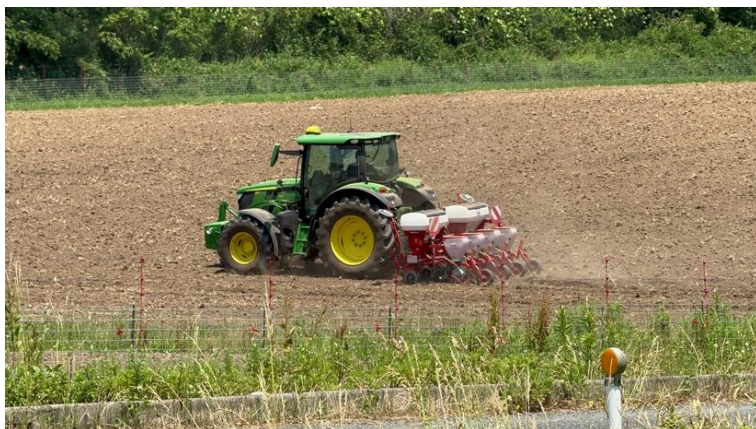
図6 オートトラクターと真空プランターによる播種
