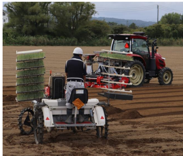
図5. ロボトラ(無人)と定植機(有人)による協調作業の様子
