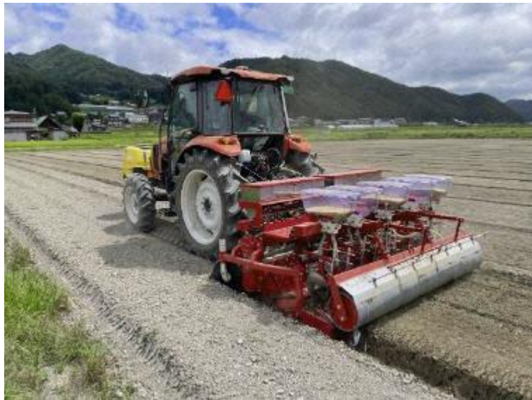
図22 ロボトラ牽引による小明渠、浅耕、播種、除草剤散布の同時作業
