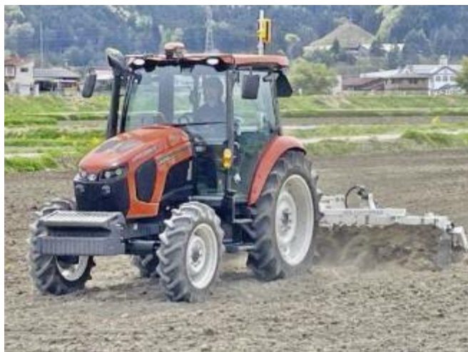
図19 レーザーレベラによる均平作業
