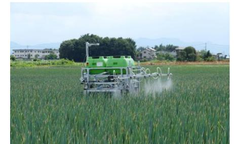
ねぎの自動農薬散布ロボット
