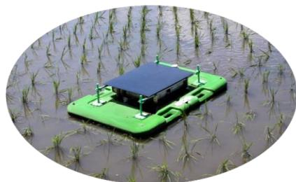
太陽光エネルギーのみで自動で稼働する「アイガモロボット」を利用し、雑草の発芽を抑制
