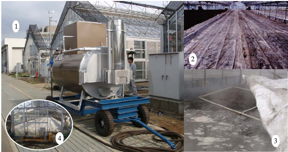
図4 熱水土壌消毒の実施風景(1:熱水調製用ボイラー, 2:チューブ式での熱水注入状況, 3:牽引式での熱水注入状況, 被覆をはずして見やすくしている, 4:牽引用ウインチ)
